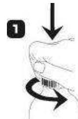
Öffnen der Flasche: Drücken Sie auf den Schraubverschluss und drehen Sie ihn gegen den Uhrzeigersinn (Abb. 1).
