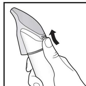
**M) Entfernen Sie die Schutzhülle** Entfernen Sie die Schutzhülle durch Hochschieben der Lasche auf der Rückseite.
