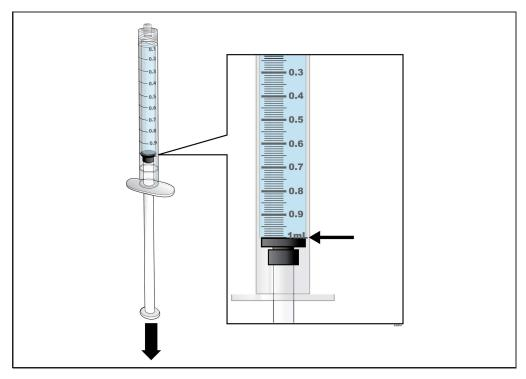
Ziehen Sie bis zur 1 ml-Markierung Luft in die Spritze
