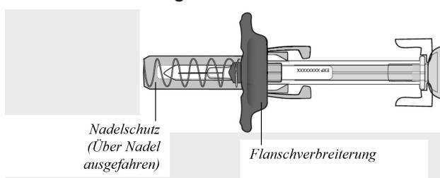
Die Fertigspritze verfügt über eine **Flanschverbreiterung**, die es einfacher macht diese zu halten und zu injizieren, und über einen **Nadelschutz**, der die Nadel nach einer vollständigen Injektion automatisch bedeckt.
