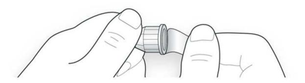
B Halten Sie die Nadel gerade und schrauben Sie sie auf den Pen, sodass sie fest sitzt. Überdrehen Sie dabei nicht das Gewinde.
