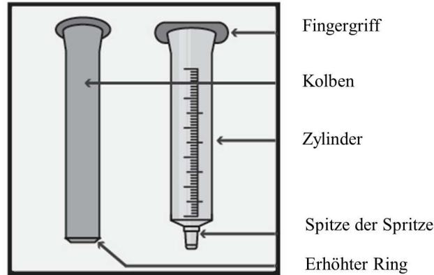
1. Schieben Sie den Kolben ganz in den Zylinder hinein.
