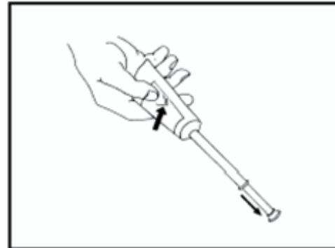
Der Applikator besteht aus einem vorn offenen zylindrischen Hohlraum mit einem darin beweglichen Kolben.
