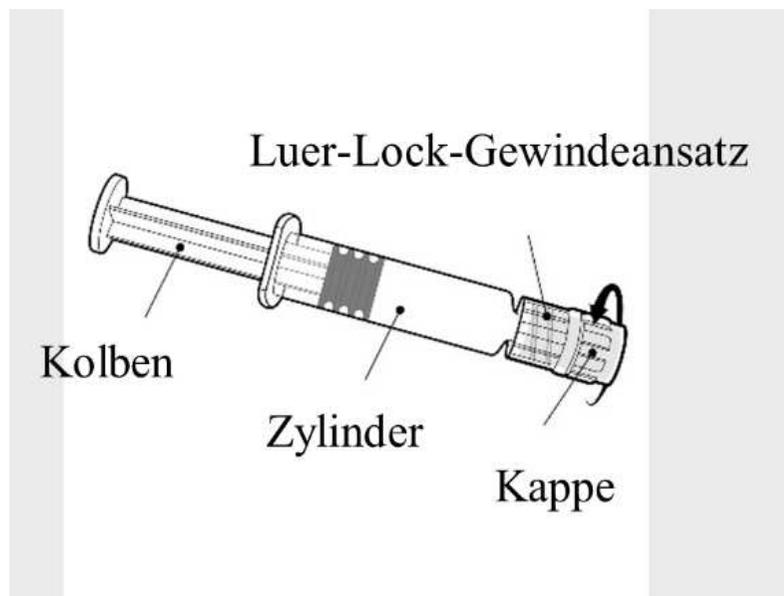
Halten Sie die Spritze am Zylinder, nicht am Kolben.
