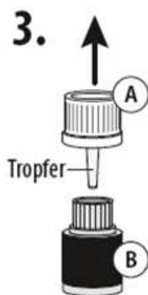
**3.** Schraubverschluss A inkl. Tropfer nach oben aus dem Schutzadapter B ziehen.
