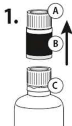
**1.** Schraubverschluss A und Schutzadapter B zusammen nach oben abziehen.
