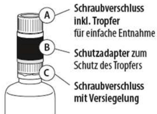
Schraubverschluss inkl. Tropfer für einfache Entnahme
