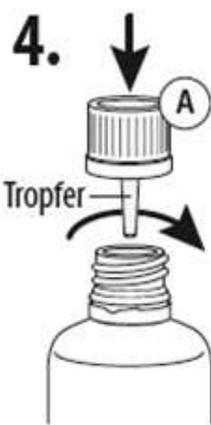
**4.** Schraubverschluss A inkl. Tropfer von oben gerade mit etwas Druck auf die Flasche schrauben. Hierdurch wird der Tropfer fest in der Flasche fixiert.
