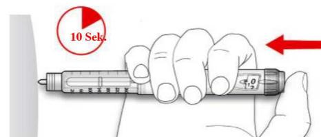
**D.** Halten Sie den Injektionsknopf vollständig eingedrückt. Zählen Sie langsam bis 10, bevor Sie die Nadel herausziehen. Dadurch wird sichergestellt, dass die gesamte Dosis abgegeben wird.
